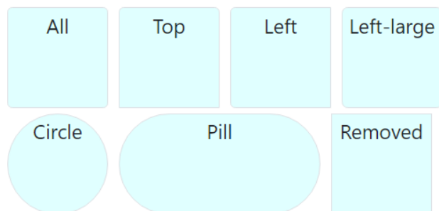
Figura 45. Diverse tipuri de chenare. Elementul cu clasa rounded-pill are lăţimea dublă faţă de înălţime
